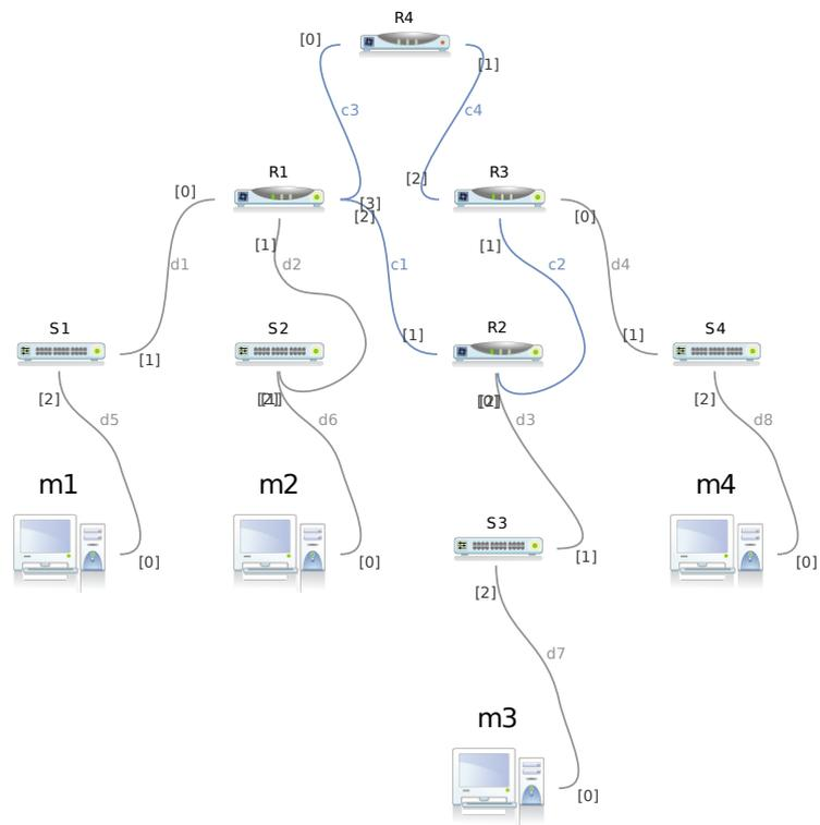
FIGURE 8 – Réseau à mettre en place pour la suite du TP
