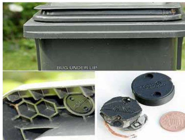
Figure 2 Exemple application RFID (poubelles connectées)
