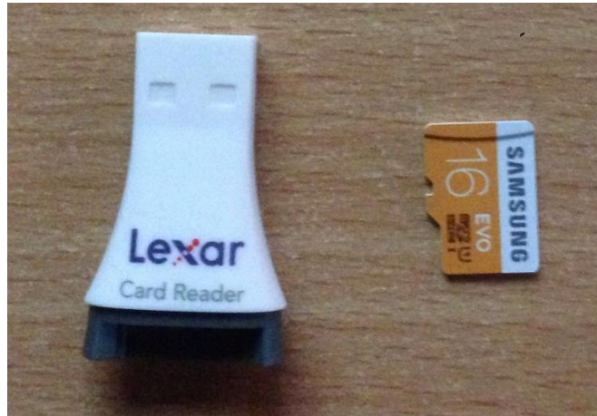
Figure 73 : Lecteur de carte MicroSD et carte SD de 16Go pour copier l'image Raspbian sur la carte.
