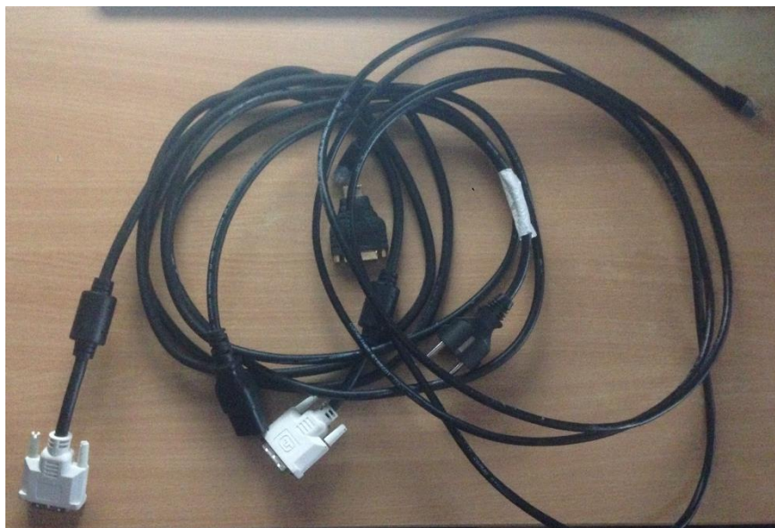
Figure 54 : Un câble d'alimentation pour l'écran, un câble DVI pour brancher le Raspberry à l'écran et avec l'adaptateur HDMI, un câble Ethernet pour accéder à Internet et faire les mises à jour.
