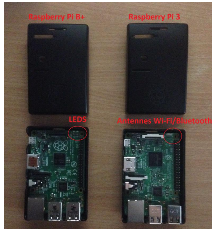
Figure 47 : Le Raspberry Pi B+ et le Pi 3, la différence cruciale pour notre projet est que le Pi 3 intègre nativement le Wi-Fi et le Bluetooth.
