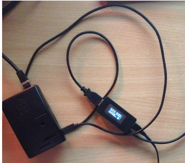
Figure 38 : Photo du montage pour observer la consommation électrique.
