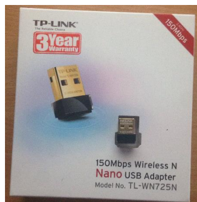
Figure 50 : Le Raspberry Pi B+ étant dépourvu d'antennes Wi-Fi/Bluetooth, il a fallu rajouter un dongle Wi-Fi, TP-Link TL-WN725N Nano Adaptateur USB Wi-Fi N 150 Mbps, valeur estimée = 8€.
