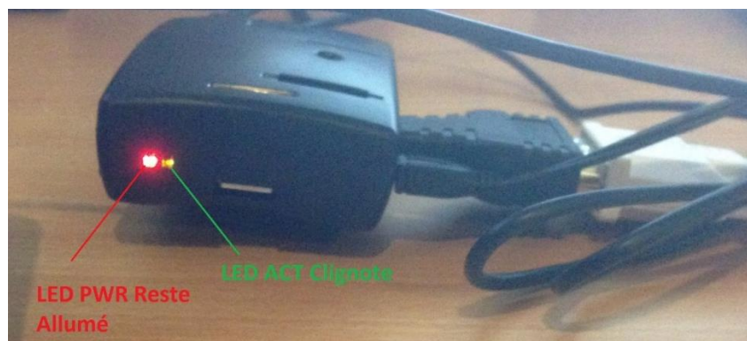
Figure 80 : Les LED permettent de nous informer que tout se déroule bien comme prévu. A noter que sur le Pi 3 les LED ne sont plus présentes et ont été remplacées par les antennes Wi-Fi/Bluetooth.
