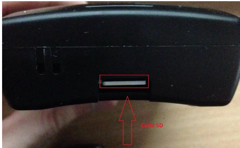
Figure 77 : Insertion de la carte SD dans le Raspberry Pi. Sur le Pi B+ la carte se clips alors que sur le Pi 3 elle se glisse.
