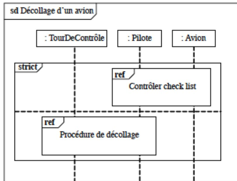
Avant de faire décoller un avion, il faut contrôler sa check-list. Le détail des interactions pour contrôler la check-list et pour faire décoller l'avion n'est pas donné. D'autres diagrammes référencés sous le label ref s'en chargent.
