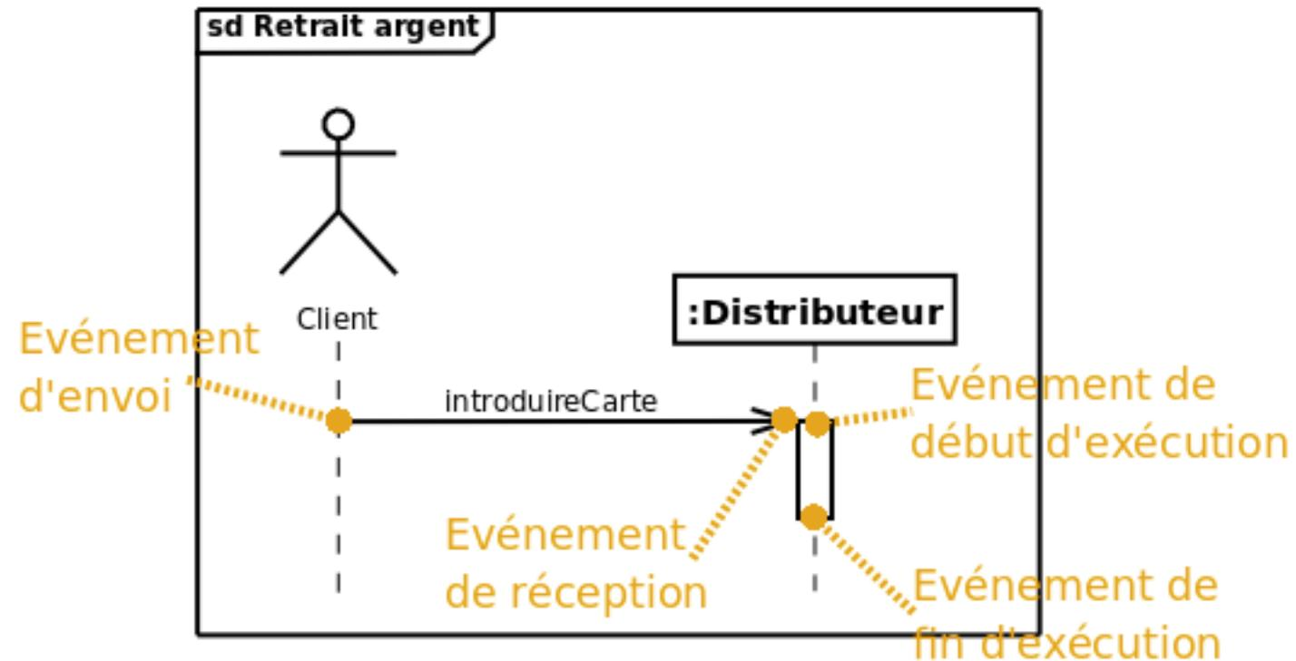
L'invocation d'une opération ou l'envoi d'un signal peut déclencher une réaction chez le Récepteur.
